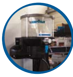
Schmierung über Permanent- schmierbuchsen oder Zentral- schmierung
