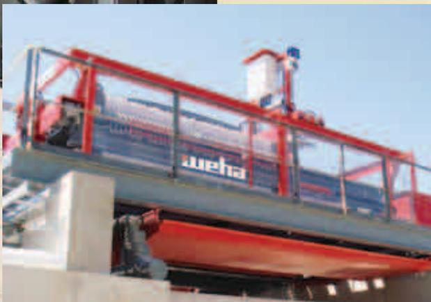
Filterpresse mit 40 Platten zu 1000 x 1000 mm und Waschroboter
