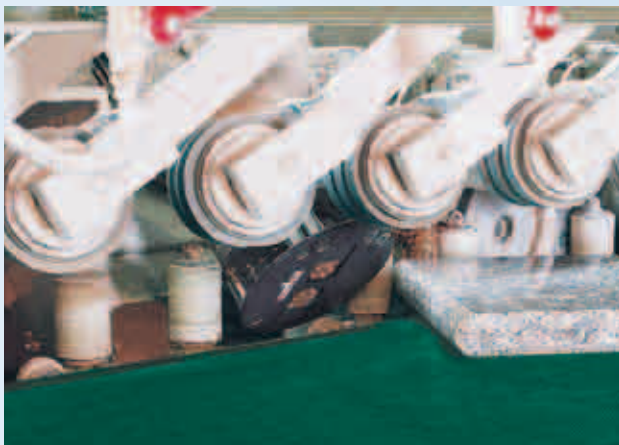
Rundprofilbearbeitung mit 2 Stockwalzen. Bullnose bushhammering with 2 rollers.
